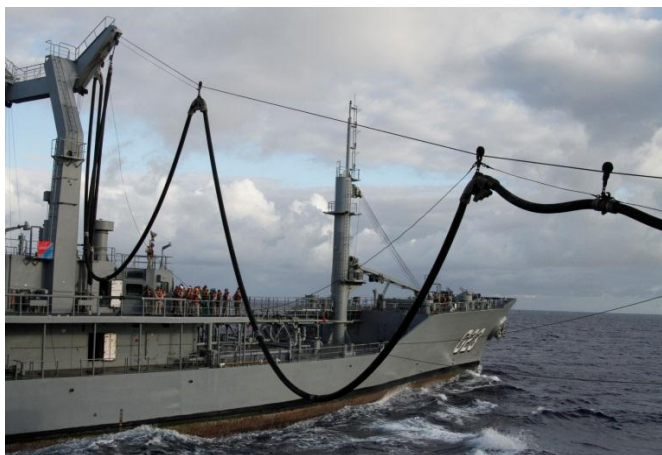
Transferência de óleo no mar entre o Navio-Tanque “Almirante Gastão Motta” e a Fragata “Greenhalgh”
